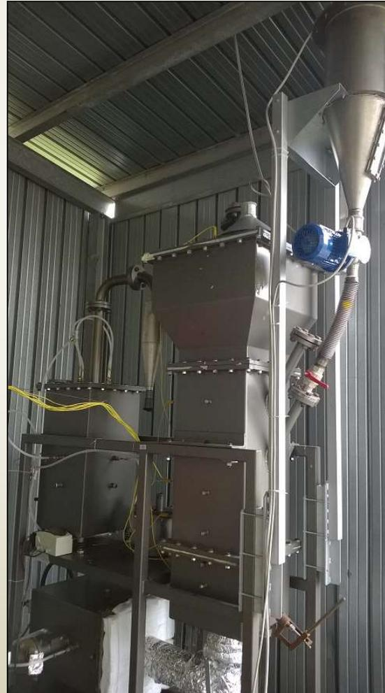
I precedenti progetti per la valorizzazione termica degli scarti tessili hanno portato alla costruzione e all'avvio di un impianto prototipale di gassificazione a letto fluidizzato basato sulla tecnologia «spouted bed».
