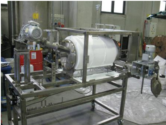
Vista primo stadio dell'impianto senza "housing" di protezione
