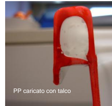
Dimostratore vano bracciolo. Le sezioni effettuate evidenziano il differente comportamento del materiale caricato ginestra
