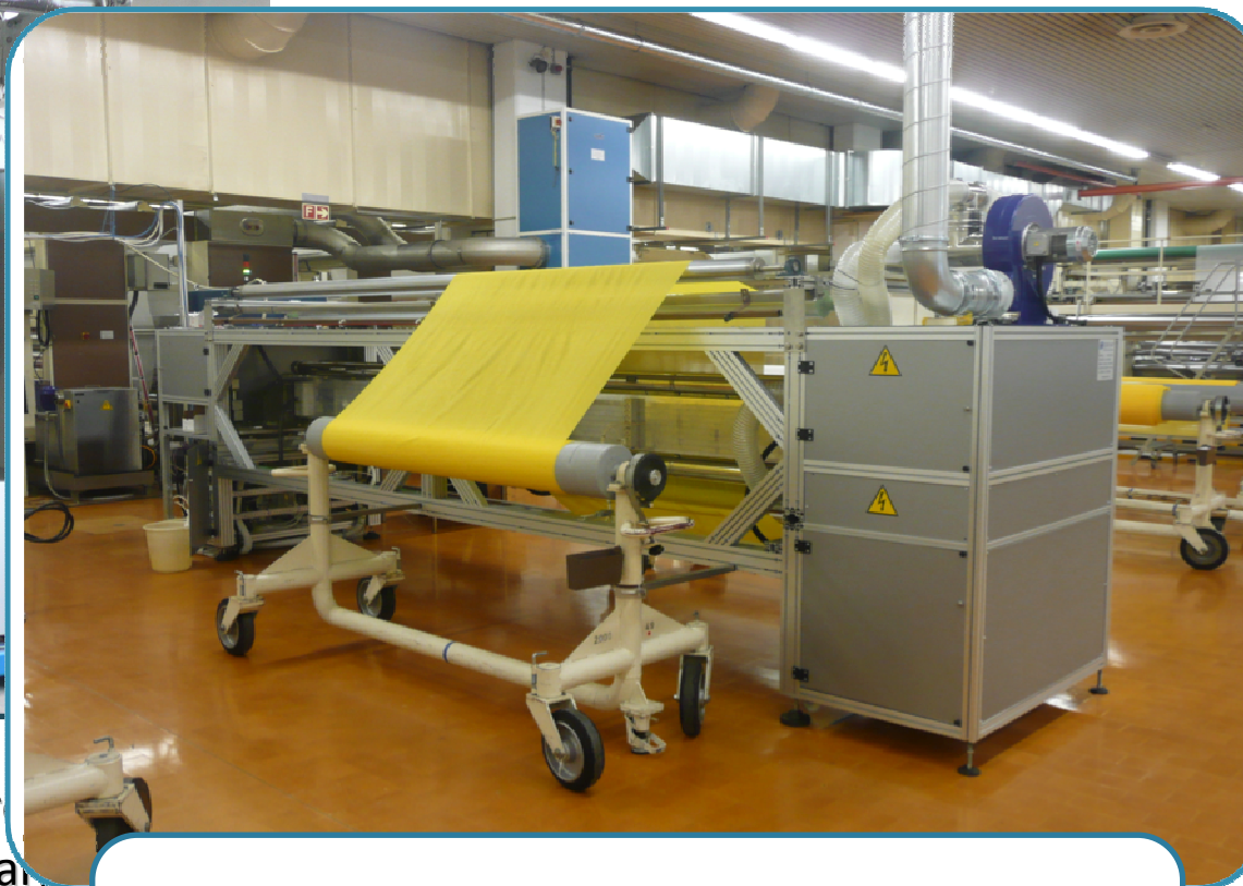
Sefar AG – Svizzera Impianto da 4 mt per il trattamento di poliestere per applicazioni screen-printing
